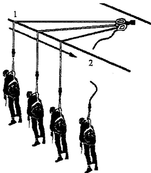
В фактор маятника должно быть включено возможное перемещение стропа по кромке от точки 1 до точки 2 с истиранием до разрыва, вызываемое маятниковым перемещением работника при его падении.
